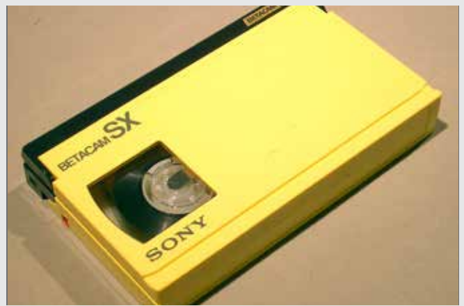
Betacam SX. Herkenbaar aan het logo en de gele kleur. Bestaat in 2 groottes.
